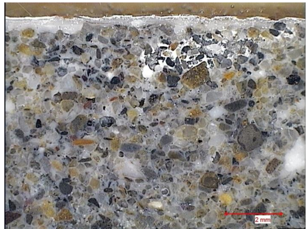
Sezione del Campione C3 . (25.0 X)
