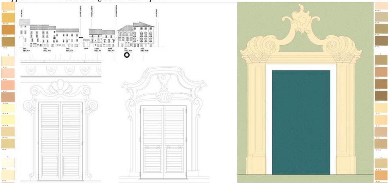
Mapp. 241 - Restituzione grafica del rilievo fotogrammetrico e cromatico delle decorazioni dipinte di facciata.
